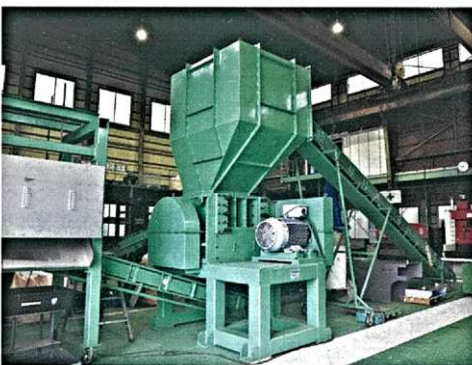
分離・破碎機「エコセパレ」。技術部の4人で設計・制作から運搬・設置までを行う
