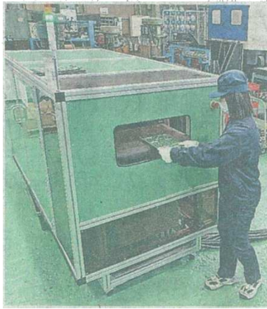
レアメタルリサイクル賞を受けたエムダイヤの基板剥離装置。滑川市中村
