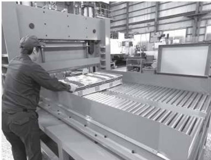
エコカッター 1500 による切断の様子
