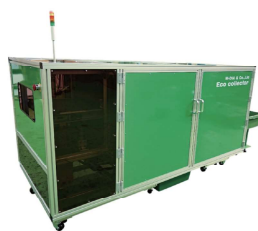
P7 基板剥離機 エココレクター®(両面)
